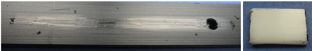
Abbildung 14: Probekörper nach 24 h Reibversuch mit v = 0,25 \text{ m/s} und F_N = 75 \text{ N} links) Gleitschiene S-Schwarz rechts) Delrin®511P glatt
