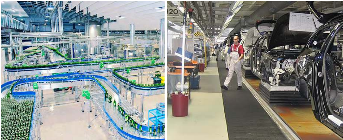
Abbildung 1: Getränkeförderanlage (links) und Werker-Mitfahrband (rechts) [Krones, VW]
