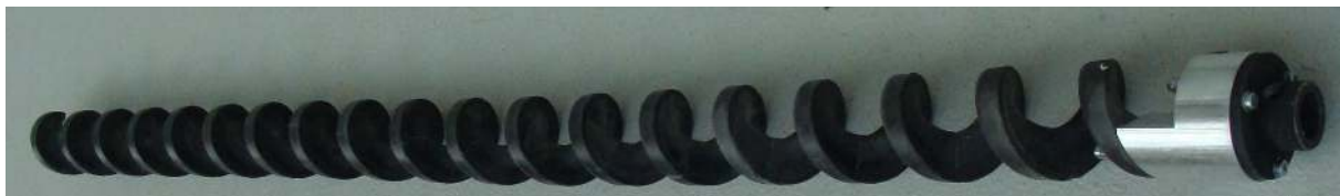
Abbildung 11: Spirale aus Kunststoffmodulen mit Antriebsflansch rechts
