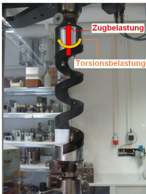
Abbildung 9: Spiralabschnitt in der Zug- und Torsionsprüfmaschine eingespannt
