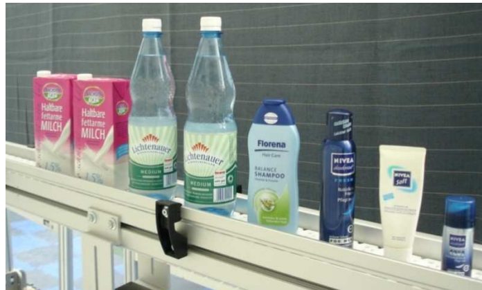
Abb. 3: Stückgüter auf einem Fördersystem mit Gleitkette aus Kunststoff
