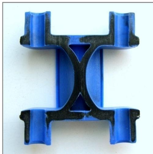
Abbildung 4 Schnitt eines im Monosandwich-Verfahren hergestellten Kettenzugelementes
