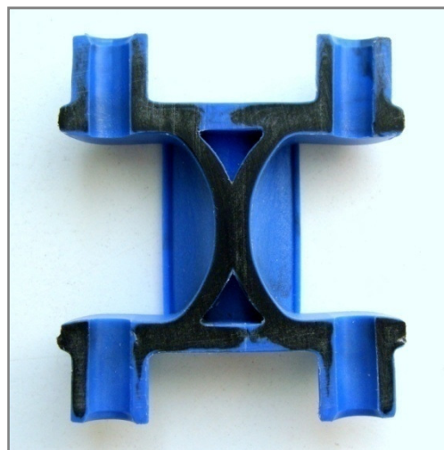
Abbildung 4 Schnitt eines im Monosandwich-Verfahren hergestellten Kettenzugelementes
